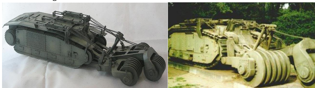
6-rasm. Char B1 bis tanki bazasiga o'rnatilgan mina trali
