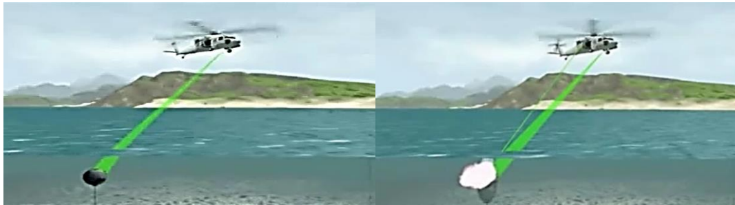
12-rasm. Daryo minalarini kontaktsiz trallash va zarasizlantirishning aviatsiya lazer tizimi (LIDAR)
