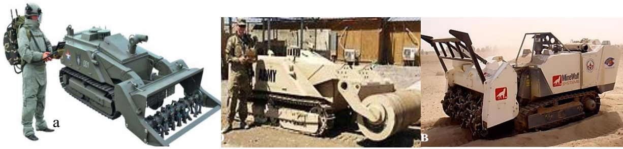
10-rasm. Mina maydonlaridan yo‘lak ochuvchi robot-sapyorlar: a-URAN-6 robot-sapyor (Rossiya); b-M-160 robot (AQSh); v- MineWolf MW240 (Germaniya)
